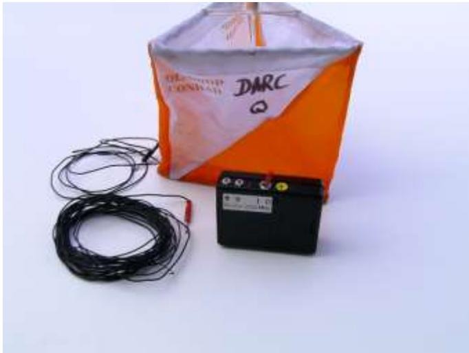
*Abbildung 1 Peilsender mit Antenne und Postenschirm*
