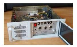
Das Amateurfunk Relais DB0RO (70cm-Teil, 439,125 MHz) wurde im Rahmen eines Technikerprojektes von Timo Schmitt, DO7TSP und Daniel Deusch, DO1DAD erneuert. Zum Einsatz kommt nun die bewährte Storno Sende-/Empfangs-Technik gesteuert von einem RaspberryPi auf dem SVXLink installiert ist.
